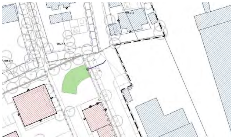
Abb. 13: Modell eingehauste Tiefgaragenrampe im WA 5
